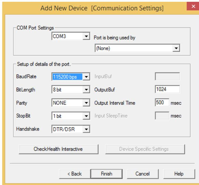
Testen Sie das Display über die Funktion „CheckHealth Interactive“ (Das Display zeigt eine Nachricht mit dem Device-Namen an). Beenden Sie die Installation des Displays über „Finish“.
