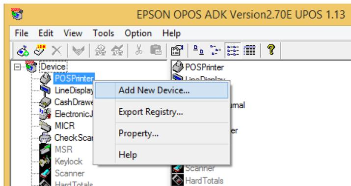
Wählen Sie unter „Select Device Name“ Ihr Bondrucker-Modell aus und vergeben Sie einen Anzeigenamen, wie z.B. „Bondrucker“, unter „Add New LDN“. Klicken Sie dann auf „Next“. Unter den „TMPORT Settings“ sollte der USB-Port des TM-20 bereits eingetragen sein.
