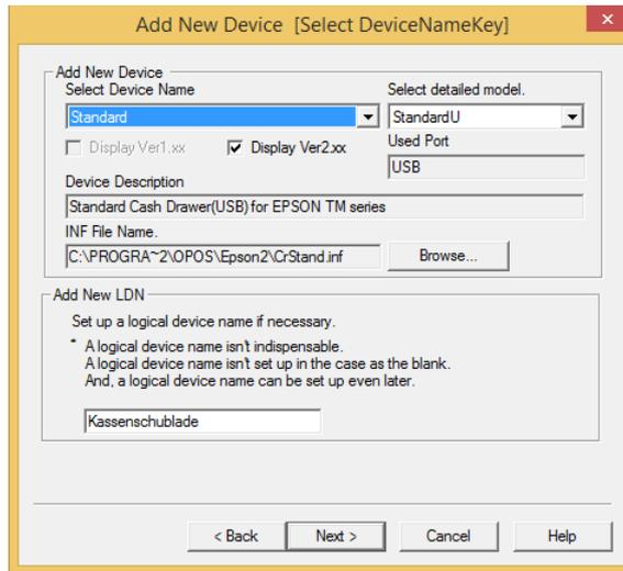
Schritt 11: Nach dem Klick auf Next wählen Sie das Druckermodell aus, mit dem die Kassenschublade verbunden ist (im Beispiel ist das „POSPrinter\TM-T20“). Im letzten Schritt sollten unter TMPORT-Settings die korrekten Einstellungen des Druckers übernommen worden sein. Über „CheckHealth Interactive“ sollte sich die Schublade vom Computer aus öffnen lassen. Beenden Sie den Health Check und wählen Sie „Finish“.
