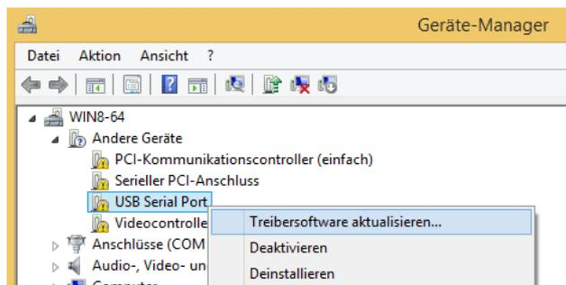
Jetzt sollte eine virtuelle serielle Schnittstelle unter der Rubrik „Anschlüsse (COM & LPT)“ für das Kundendisplay reserviert sein. Notieren Sie sich den COM-Port, der im Namen angezeigt wird (im Beispiel „3“). Gehen Sie zuletzt in die Einstellungen des virtuellen COM-Ports über das Kontextmenü und setzen Sie die Baudrate auf 115.200.
