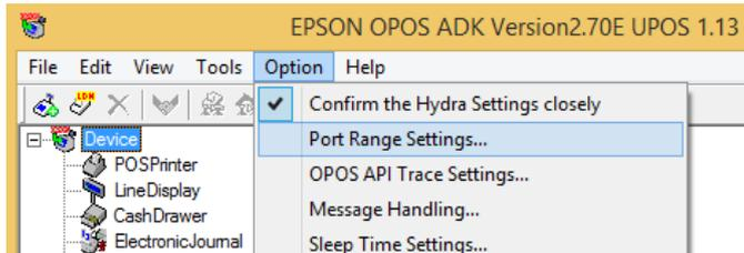
Stellen Sie sicher, dass der im vorhergehenden Schritt notierte COM-Port für das Display im ausgewählten Bereich enthalten ist. Vergrößern Sie den COM-Port-Bereich bei Bedarf entsprechend, in dem Sie unter „Maximum COM ports“ den Wert erhöhen (im Beispiel mindestens „3“).
